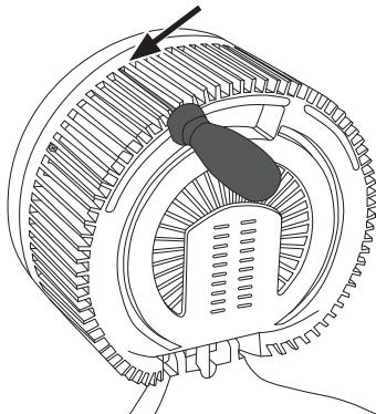
2. Vrid skyddskåpan i pilens riktning och ta loss den.
