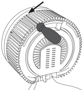
2. Die Schutzabdeckung in Pfeilrichtung drehen und abnehmen.
