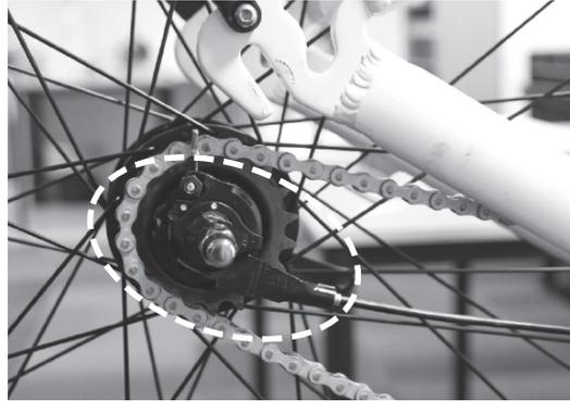
(Huomio! Kuvassa pyörä on irrotettu takahaarukasta ja ketjusuoja on otettu pois, jotta ulkoinen vaihdemekanismi näkyisi)
