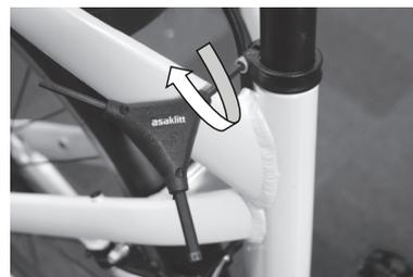
1. Løsne setepinneklemsens (L4) unbrakoskrue (5 mm).
