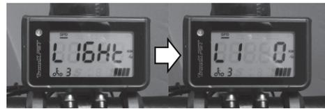
2. Auf [ ] drücken, bis kurzzeitig „L16H...“ auf dem Display erscheint, gefolgt von „L1“ sowie dem aktuell eingestellten Wert von -15 bis 15.
