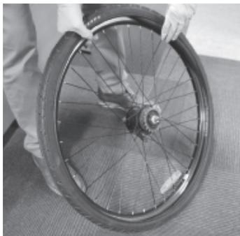
5. Pidä kiinni venttiilistä ja paina renkaan sivu venttiiliin kohdalta vanteelle.
