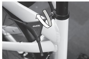
1. Die Innensechskantschraube (5 mm) an der Sattelstützenklemme (L4) lösen.
