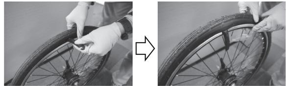
3. Skyv en dekkspak under dekkanten midt mot ventilen. Bend opp dekkanten, og fest dekkspaken i en eike.
