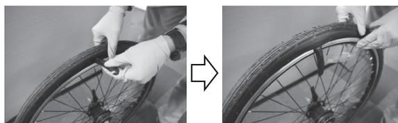
3. Tryck in en däckavtagare under däckkanten mitt emot ventilen. Bänd upp däckkanten och fäst däckavtagaren i en eker.
