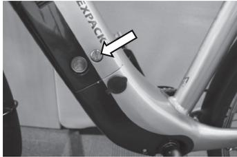
Hvis du ikke slår av elsystemet med hovedstrømbryteren på rammen/batteriet, kan du slå det på og av med kontrollenheten på styret.
