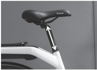
2. Die Sattelstütze (L3) drehen und hochziehen oder einschieben, um die richtige Sattelhöhe einzustellen.
