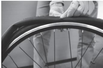
4. Den Schlauch am gesamten Reifenumfang in den Reifen einführen.
