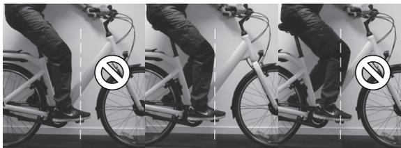
3. Kontrollieren, dass sich die Spitze des Knies auf einer vertikalen Linie oberhalb der Pedalachse/des Zehengelenks befindet.
