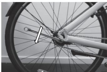
8. Skjut hjulet nedåt /framåt så att hjulaxeln släpper från bakgaffeln (W8).
