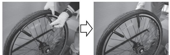
4. Bruk en eller to dekkspaker til med ca. 10–15 cm mellomrom til hele dekkensiden slipper fra felgkanten.
