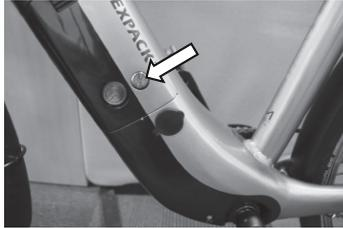
Om du inte stänger av elsystemet med huvudströmbrytaren på ramen/batteriet kan du stänga av och starta med kontrollenheten på styret.
