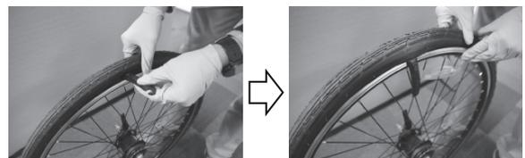
3. Einen Reifenheber an der dem Ventil gegenüberliegenden Seite zwischen Mantel und Felge schieben. Den Mantel durch eine Hebelbewegung über die Felge schieben und den Reifenheber an einer Speiche befestigen.
