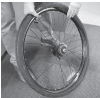
5. Hold tak i ventilen, og press dekk siden ved ventilen over felgkanten.
