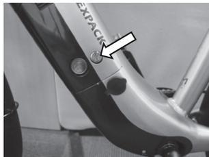
Jos sähköjärjestelmää ei kytketä pois päältä rungon/akun päävirtakytkimen kautta, sen voi kytkeä pois ja päälle ohjaustangossa olevan ohjausyksikön avulla.
