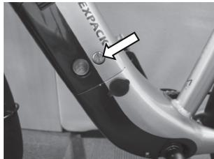
Wird das Elektrosystem nicht mit dem Hauptschalter am Rahmen/Akku ausgeschaltet, kann es mit der Bedieneinheit am Lenker aus- und eingeschaltet werden.
