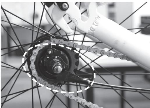
(Obs! Hjulet har lossats från bakgaffeln och kedjeskyddet har demonterats för att den yttliga växelmekanismen ska synas)
