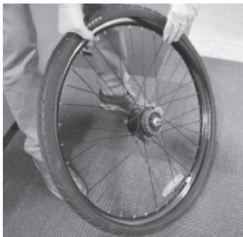
7. Den Schlauch aufpumpen und anschließend die Luft ablassen.
