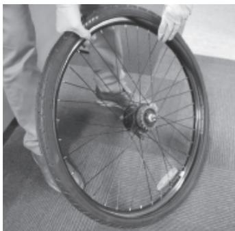
5. Håll i ventilen och pressa däcksidan vid ventilen över fälgkanten.
