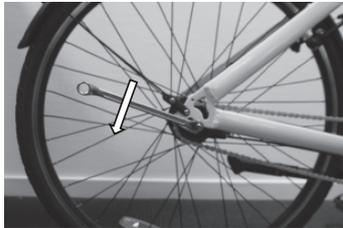
8. Das Rad nach unten/nach vorne schieben, sodass sich die Radachse von der Hinterradgabel (W8) löst.
