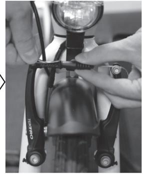
5. Prøv bremsene for å kontrollere funksjonen (se *Bremser* i avsnittet *Innstillinger og justeringer*).
