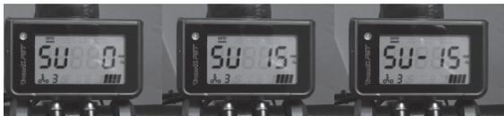
4. Das ausgewählte Drehmoment wird auf dem Display (C5) angezeigt.
