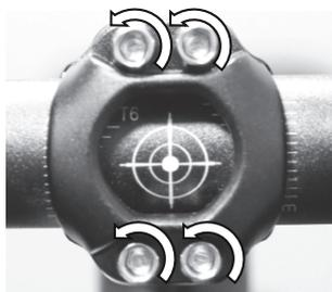
2. Den Lenker nach oben/unten in den gewünschten Winkel bringen und sicherstellen, dass das Steuerrohr mittig am Lenker sitzt.
