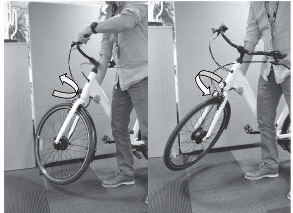
1. Ta tak under diagonalrøret (W2) med den ene hånden, og løft sykkelen slik at forhjulet (U) heves fra bakken.
