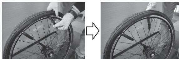
4. Använd ytterligare en eller två däckavtagare med ca 10–15 cm mellanrum tills hela däcksidan släpper från fälgkanten.
