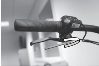
2. Den Hebel am Lenker nach innen oder außen verschieben und/oder in den gewünschten Winkel drehen.
