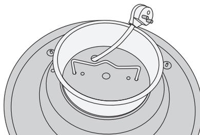
1. Den innkommende strømkabelen eller en lampekontakt med kabel (selges separat) kobles til koblingsplinten. Monter deretter opphengsbøylen og legg den medfølgende distanseringen på plass.
