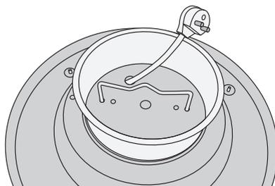
1. Liitä sisään tuleva sähköjohto tai lamppupistoke ja johto (myydään erikseen) liitinriimaan, asenna ripustussanka ja aseta mukana tuleva välikerengas paikalleen.
