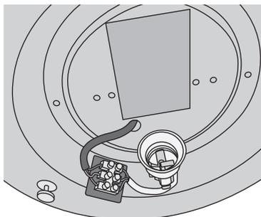
3. Koble innkommende kabel til koblingsplinten. Benytt de 3 medfølgende isolerende kabeldekslene hvis du har 3 separate ledninger som kommer ut fra taket.
