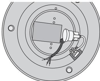
2. Skyv den innkommende kabelen gjennom hullet i armaturen og skru opp armaturen direkte i taket med passende festemiddel.
