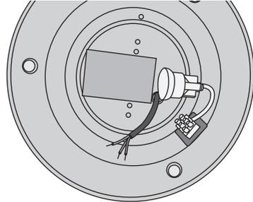
1. Käytä valaisimen kiinnitysreikää ja merkitse mahdollinen porauskohta. **△ Huom.!** Varmista että poraus-/ruuvauskohdassa ei ole sähkö- tai vesijohtoja.
