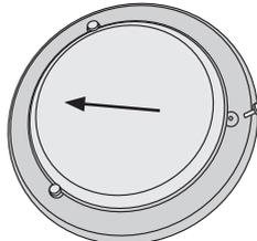
2. Lampekontakten kobles til takuttaket. Heng deretter opp armaturen på takkroken. Spenn armaturen fast mot taket, ved å trekke til opphengsbøylens vingemuttere.
