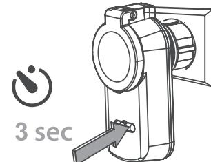
3. LED-indikatoren på knappen starter å blinke langsomt. Mottakeren er nå klar til å kobles sammen med en fjernkontroll/sender. **Obs!** Knappen skal blinke etter at du har sluppet den opp. Hvis knappen blinker mens den holdes inne, vil ikke sammenkoblingen fungere.
