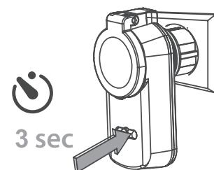
3. LED-indikatorn i knappen börjar blinca långsamt. Mottagaren är nu redo att kopplas samman med en fjärrkontroll/sändare.
