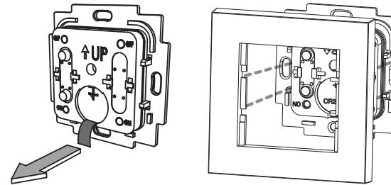
3. Trekk ut plastfliken for å aktivere batteriet.
