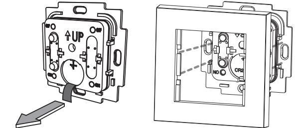
3. Zum Aktivieren der Batterie den Kunststoffstreifen entfernen.
