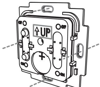
2. Kiinnitä virtakytkin haluamaasi paikkaan mukana tulevilla ruuveilla. **Huom!** Virtakytkin on tärkeää asentaa oikein päin. Noudata virtakytkimessä olevaa UP-merkintää (ylöspäin).
