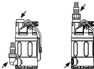
Till universalslanganslutningen kan du ansluta en slang med diameter 38 mm (1 ½") eller 25 mm (1"), eller få en utvärdig 1" gänga. Slang med diameter 38 mm ger bästa kapaciteten. Används 38 mm slanganslutningen eller 1" gänganslutningen ska nippeln (A) kapas som bilden visar.
