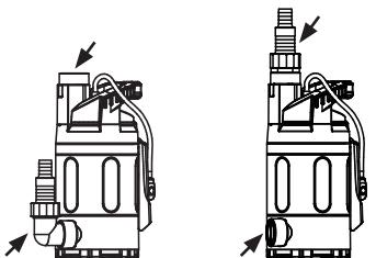
An den Universalschlauchanschluss passen Schläuche mit Durchmesser 38 mm (1 ½") oder 25 mm (1") oder ein 1" Außengewinde. Der Schlauchdurchmesser 38 mm liefert die optimale Leistung.
