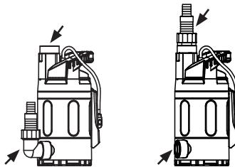
En slange med diameter 38 mm (1 1/2") eller 25 mm (1") eller med utvendige gjenger på 1" kan kobles til universaltilkoblingen. Slange med diameter på 38 mm gir den beste kapasiteten.
