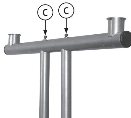
6. Monter foten med skruene C, trekk til skruene og snu så kløyveren, så den står riktig vei igjen.
