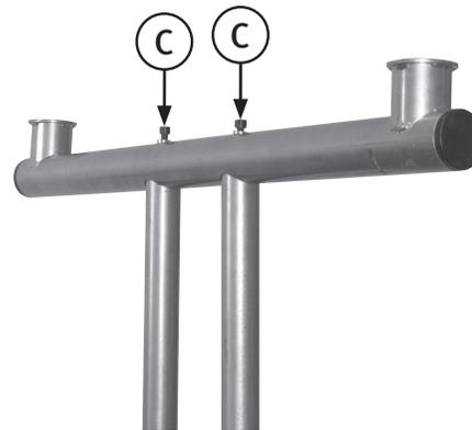
6. Den Fuß mit den Schrauben **C** montieren, die Schrauben anziehen und dann den Holzspalter wieder richtig herum aufstellen.
