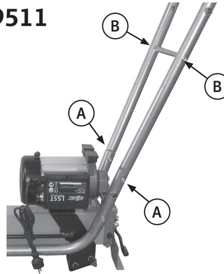
3. Zuerst die Beinverlängerung an der Motorseite mit den Schrauben **A** montieren, dann die Querstange zwischen den Beinen mit den Schrauben **B** (die Schrauben nicht komplett anziehen).
