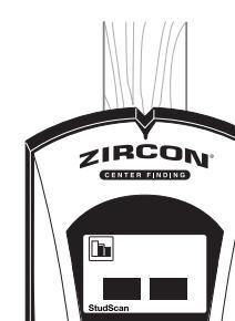
Om regeln ligger djupt (eller om ytmaterialet är tjockt), kommer endast en eller två staplar att visas på signalstyrkeindikatorn, samtidigt som några av mittensymbolerna på föremåls-indikatorn tänds i displayen. Om regeln fortfarande inte kan hittas prövar du nästa steg.
