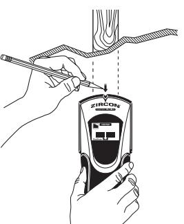
**! VARNING** Verktyg som detekterar elektriska fält kan i vissa fall misslyckas med att indikera förekomst av strömförande elledningar. Detta gäller om det finns fukt i väggen, om ledningarna ligger djupare än 50 mm in i väggen, inuti ledningsrör, bakom puts på plywood eller där väggfärg eller tapet innehåller metall.
