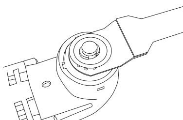
4. Die Arretierscheibe wieder aufsetzen und den Drehriegel komplett zurück drehen.
