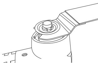
3. Vrid tillbaka låsvredet så att det står rakt ut, i 90° från multiverktyget. Låsbrickan kan inte lossna från fästet när låsvredet står i det här läget.
