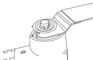
3. Den Drehriegel zurückdrehen, sodass er im 90°-Winkel zum Multiwerkzeug steht. Die Arretierscheibe kann sich nicht von der Werkzeugaufnahme lösen, wenn der Drehriegel in dieser Position steht.
