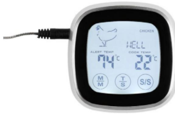
**i** Tänk på att placera mätsondens spets i råvarans tjockaste del. Skjut inte in den så långt att den nästan sticker ut på andra sidan. Undvik partier som innehåller mycket fett.
