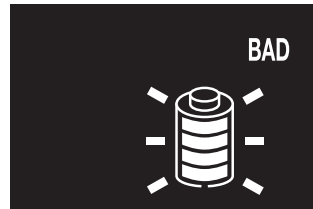
Batteriet er plassert feil i laderen eller det er ødelagt
